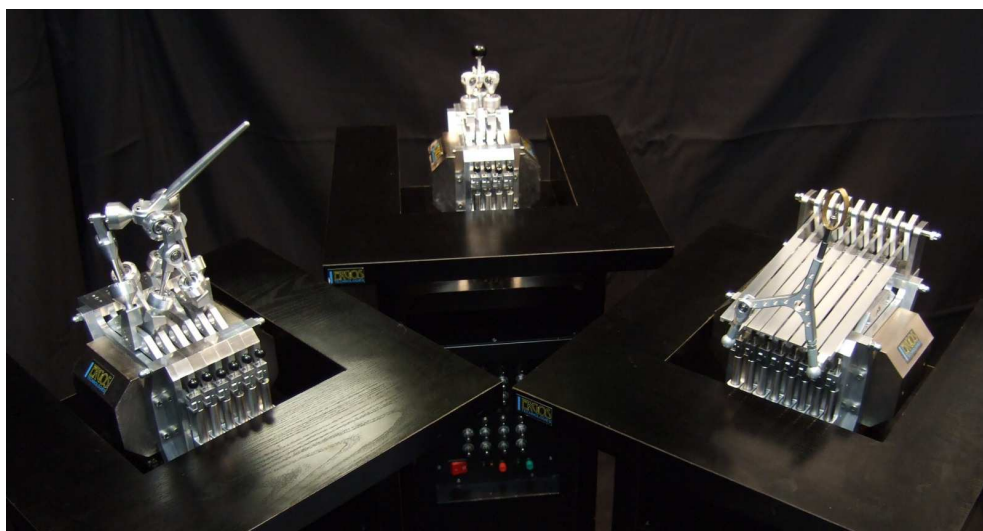
Figure A.1. Trois systèmes ERGOS équipés de différents habillages mécaniques : à gauche, un stick 6D, au milieu un stick 3D, à droite un archet
